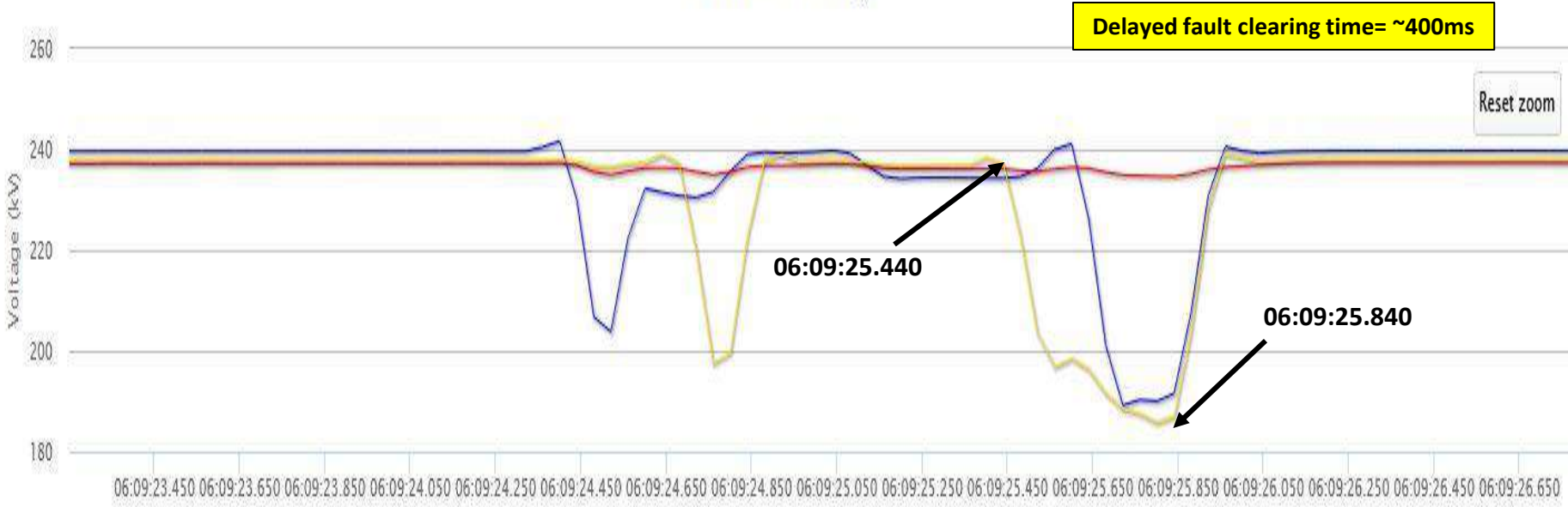
R Y B Phase Voltage
